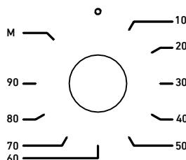
Consente di impostare il tempo di cottura del cibo. È possibile regolare il tempo di cottura selezionando la temperatura e il tipo di cottura e ruotandolo in senso orario. Quando il tempo è scaduto, emette un avviso con un suono squillante. Se vuoi, puoi passare alla modalità M e iniziare la cottura selezionando la temperatura e il tipo di cottura senza scegliere un tempo.
