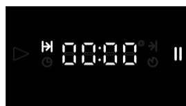
Per il tempo di cottura selezionare prima i minuti con i pulsanti -/+ e attivare il tempo premendo il pulsante OK.
