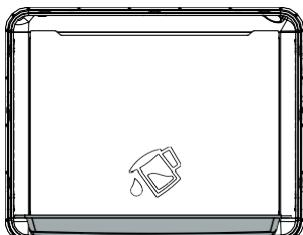
Dopo la cottura, lo sporco può essere facilmente rimosso ammorbidente. Estrarre tutti gli accessori (se è presente una griglia) all'interno del forno. Posizionare una sola teglia sulla base inferiore con un po' d'acqua e selezionare la funzione Calore inferiore  e farla funzionare per 100°/20 minuti. Al termine del processo, pulire l'interno del forno con un panno umido o una spugna.
