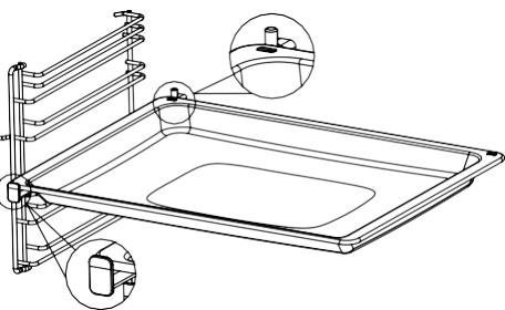
Schieben Sie die Schienen bis zum Anschlag ein, ohne das Backblech und das Drahtgitter darauf zu platzieren. Das Zubehör muss sich zwischen den vorderen und hinteren Vorsprüngen der Schienen befinden.
