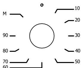
Damit können Sie die Zeit für das Backen einstellen. Durch Drehen im Uhrzeigersinn können Sie die Temperatur und die Backart auswählen und die Backzeit einstellen. Wenn die Zeit abgelaufen ist, warnt es mit einem Glockenton. Wenn Sie möchten, können Sie in den Modus M wechseln und mit dem Backen beginnen, indem Sie die Temperatur und die Backart auswählen, ohne die Zeit einzustellen.
