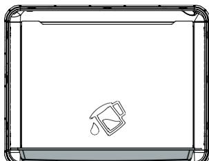
Nach dem Backen kann der Schmutz aufgeweicht und leicht abgewischt werden. Entfernen Sie alle Zubehörteile im Inneren des Backofens (falls ein Gitterrost vorhanden ist). Stellen Sie das einzelne Blech mit etwas Wasser auf den Boden, wählen Sie die Funktion untere Heizung  und schalten Sie den Ofen für 100%/20 Minuten ein. Wischen Sie das Innere des Ofens am Ende des Vorgangs mit einem feuchten Tuch oder Schwamm ab.
